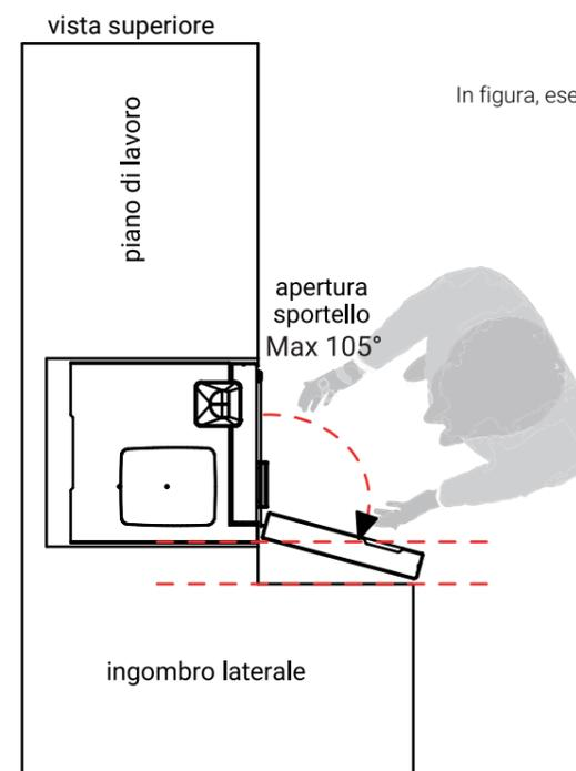
Per non ostacolare l'estrazione dei moduli interni e facilitare la manutenzione del prodotto, **consentire una completa apertura dello sportello, come in figura (min. 105°).**
