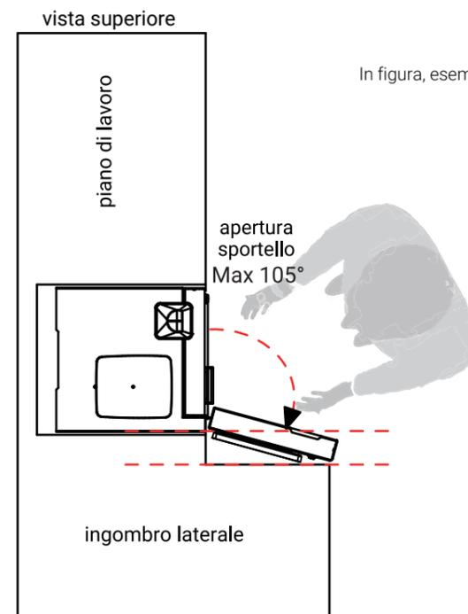
Per non ostacolare l'estrazione dei moduli interni e facilitare la manutenzione del prodotto, **consentire una completa apertura dello sportello, come in figura (min. 105°).**
